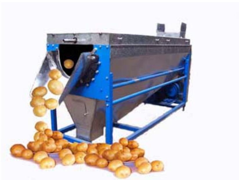
**Машина плодомоечная универсальная** (в дальнейшем - машина) предназначена для быстрой и высококачественной мойки и одновременной полировки широкого ассортимента овощей, корнеплодов и фруктов различной формы. Машина способна эффективно мыть: картофель, морковь, редис,
